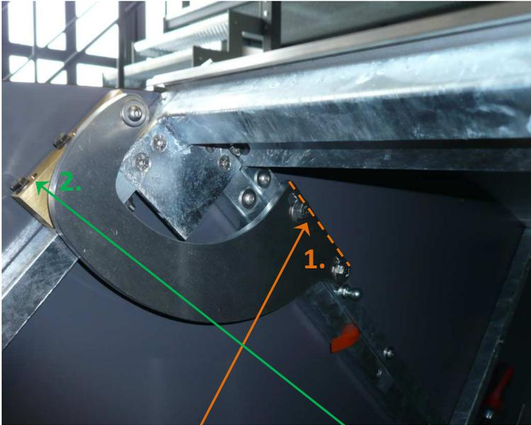
Das Scharnier muss hier bündig aufliegen und dann **die 6kt-Schrauben festziehen**. Als zweites die anderen **6kt-Schrauben festziehen**.
