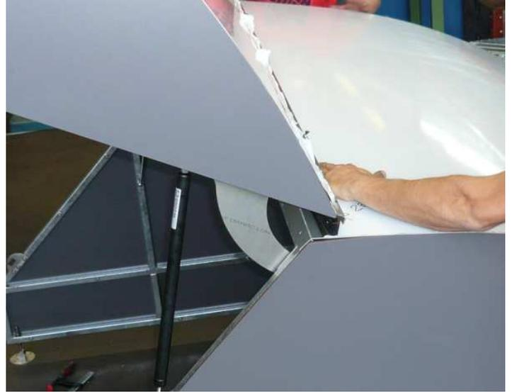
Hinteres Blechdach nach oben wölben und vorne unter den Deckel schieben.
