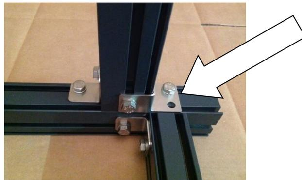
**7) Dachbogen rechts vorbereiten, Winkel und Doppel-Winkel montieren**
