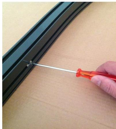
Nutenstein mit Schraubenzieher in Position schieben
