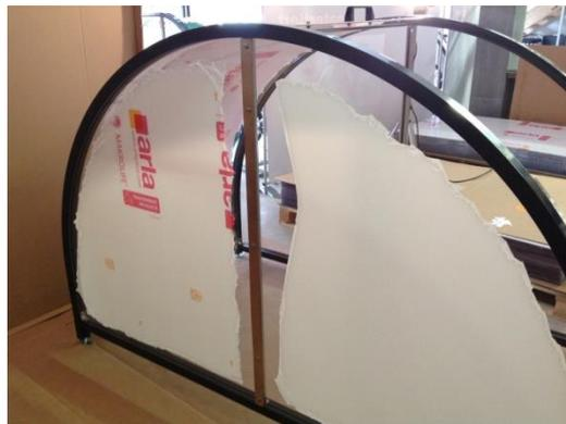
**23) Vertikaltraverse innen, unten mit Längsverbinder verschrauben**
