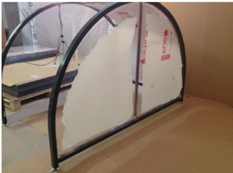
20) Längsverbinder anlösen und durch zwei Personen links und rechts mit den Seitenscheiben hochschieben. Anschliessend wieder festziehen.
