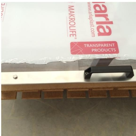
Abschluss-Falzblech hinten montieren
