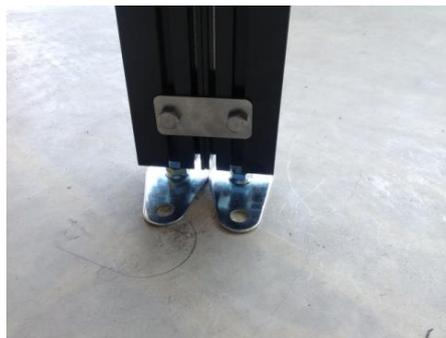
Das Bild links zeigt die fertige Box. Die Boxelemente links und rechts können unabhängig voneinander aufgebaut und am Schluss verbunden (Bild rechts) werden.
